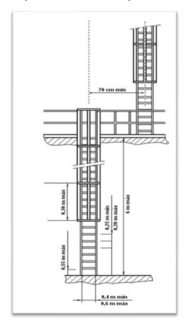
j) Distância em relação à estrutura em que é fixada de, no mínimo, 0,15cm (quinze centímetros), conforme figura abaixo:
