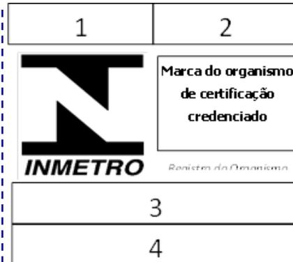
A marcação, junto com o certificado de conformidade INMETRO, garante que o equipamento eletroeletrônico foi aprovado em testes prescritos em normas brasileiras, demonstrando-se incapaz de incitar uma mistura explosiva.
