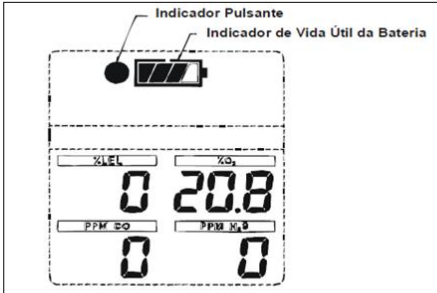
Figura 07 – Indicador Pulsante – Indicador de Bateria
